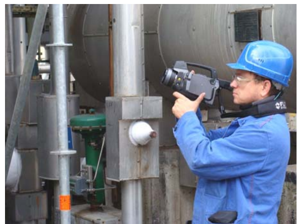
Bild 7: Prüfung von Chemieanlagen mit der GF320-Kamera als Dienstleistungsmessung
