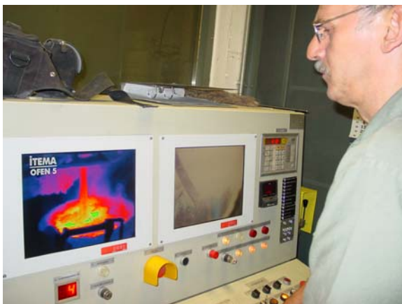
Bild 11: Integration eines Schlackendetektionsystems in den Leitstand eines Stahlwerkes
