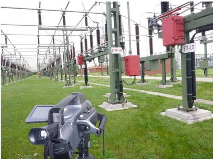
Bild 4: Einsatz der Gaskamera in einem Umspannwerk
