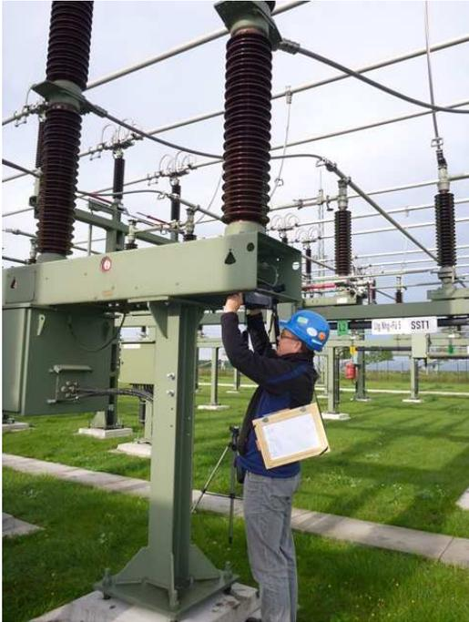
Bild 3: Einsatz der Gaskamera an einem 110kV-Schalter
