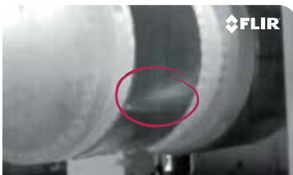
Erfasstes Gasleck an einem Produktionsstandort.
